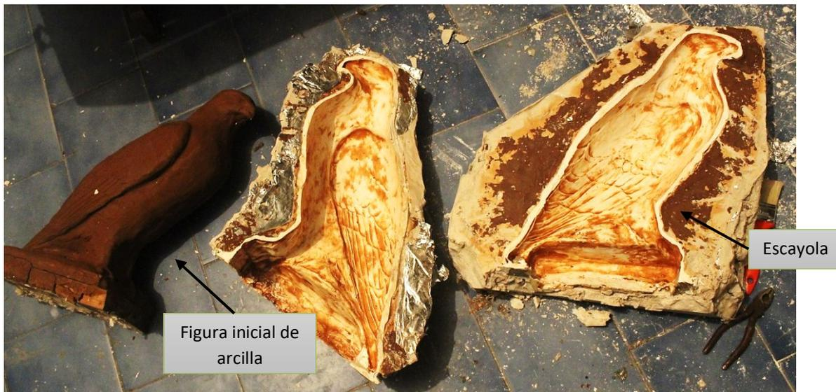
**4. Realización de la figura definitiva en cemento.** Se unen las dos piezas del molde y a través del hueco que queda por la parte inferior de la figura final se rellena con un mortero bastante líquido de cemento blanco con arena de sílice (se utiliza para filtros de piscina) y una cantidad de arcilla expandida que sirve para aligerar la figura.
