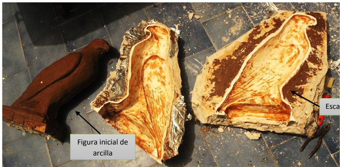
**4. Realización de la figura definitiva en cemento.** Se unen las dos piezas del molde y a través del hueco que queda por la parte inferior de la figura final se rellena con un mortero bastante líquido de cemento blanco con arena de sílice (se utiliza para filtros de piscina) y una cantidad de arcilla expandida que sirve para aligerar la figura.
